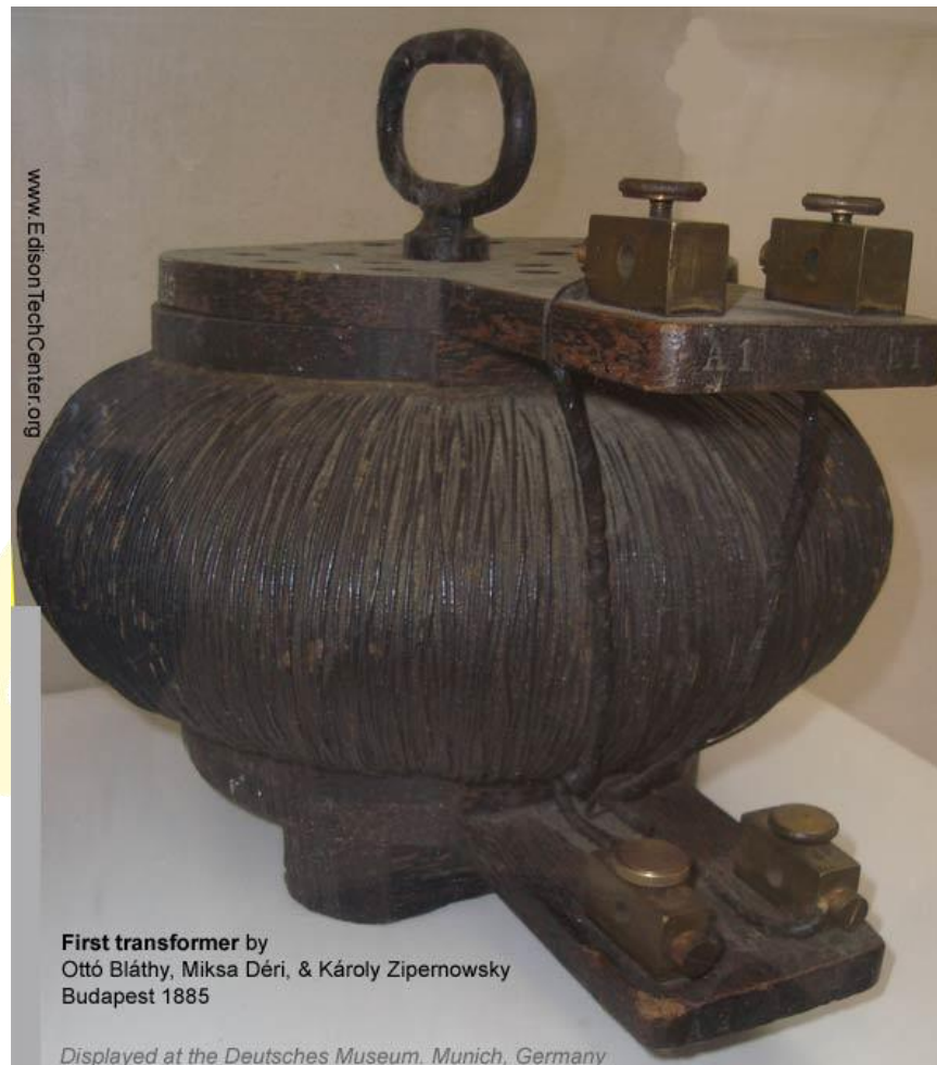
Фиг.1 – първият патентован трансформатор
